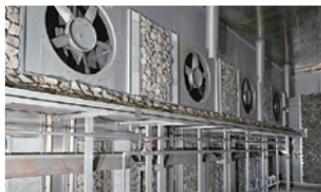
改質水と抗火石を使った高速木材乾燥技術。乾燥時間を短縮するだけでなく、水分を効率よく蒸発させることで、カビ、割れ、反り、曲がりを抑えた高品質な木材を作ることができます。
